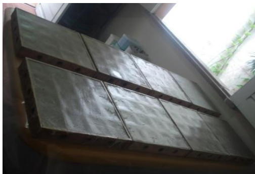
Figura 3.46: Placas no período de cura. Foto do autor, 2014.
