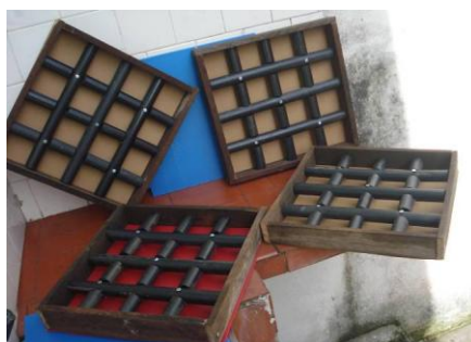
Figura 3.32: Formas e estruturas taipais tubulares. Fotos do autor, 2013.
