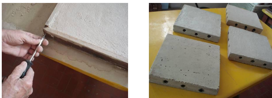
Figuras 4.9 e 4.10: Desforma das primeiras placas fundidas e placas desformadas. Foto: Cybelle Miranda, 2013.
