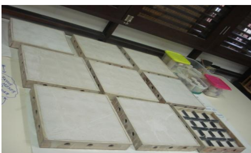
Figura 3.48: Placas prontas para desforma. Foto do autor, 2014.
