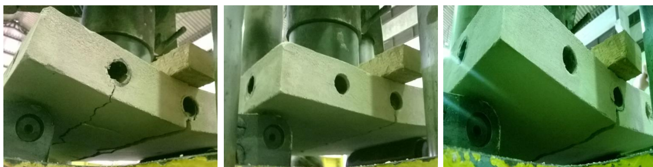
Figuras 4.19 a 4.21: Ensaio de flexão simples das placas 4, 5 e 6. Foto: Bianca Barbosa, 2014.
