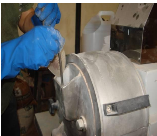
Figuras 3.25 e 3.26: Material da 1º peneiragem sendo moído e peneirado em malha #65. Fotos do Autor. 2012 .
