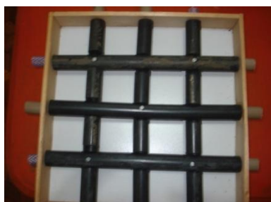
Figura 3.42: Parafusamento dos dutos. Fotos do autor, fevereiro, 2014.
