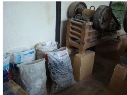
Figuras 3.22 e 3.23: Britadeira de mandíbula e rejeitos embalados prontos para britagem. Fotos do autor, 2012.
