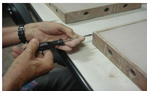
Figura 3.49: Desparafusando as formas. Foto: Amanda Farias, 2014.
