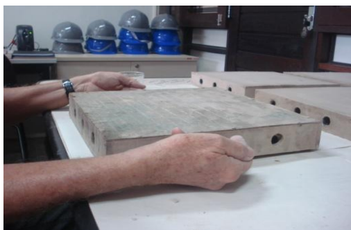
Figura 3.50: Inicio da retirada da forma. Foto: Amanda Farias, 2014.
