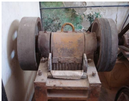
Figuras 3.22 e 3.23: Britadeira de mandíbula e rejeitos embalados prontos para britagem. Fotos do autor, 2012.
