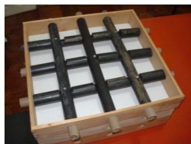
Figura 3.43: Fixação da estrutura na fôrma e distância às superfícies da placa. Fotos do autor, fevereiro, 2014.
