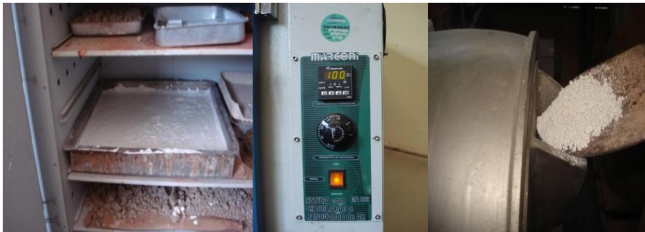
Figuras 3.29 a 3.31: Processo de secagem e moagem da cal hidratada. Fotos do Autor, 2012.
