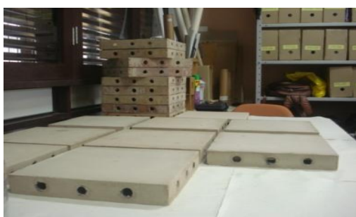
Figura 3.52: Placas desformadas. Foto do autor, 2014.
